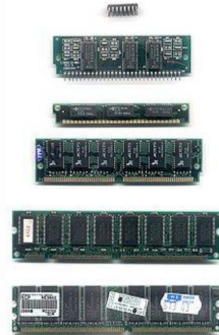
Diferite tipuri de RAM. De sus în jos: DIP, SIPP, SIMM 30 pini, SIMM 72 pini, DIMM 168 pini, DDR DIMM 184 pini.
